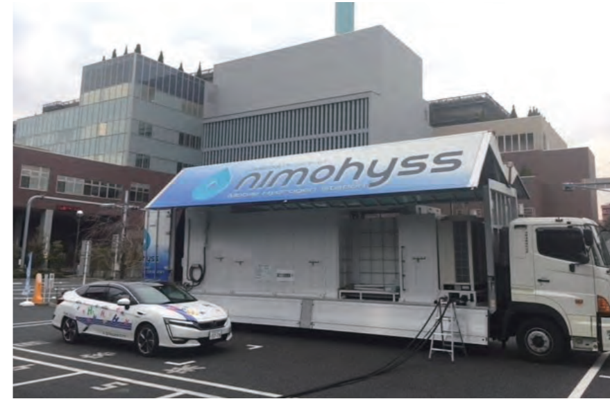
移動式水素ステーションから燃料電池自動車(FCV)に水素を供給している様子
