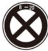
No Parking or Stopping 駐停車禁止
