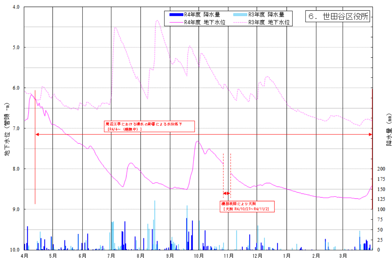
図 5-6 地下水位変動図【地点 A-6 世田谷区役所第二庁舎裏】
