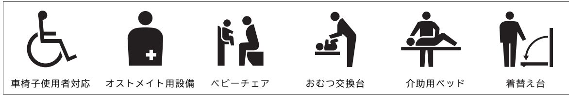
【図13-3】 便房設備の表示例
