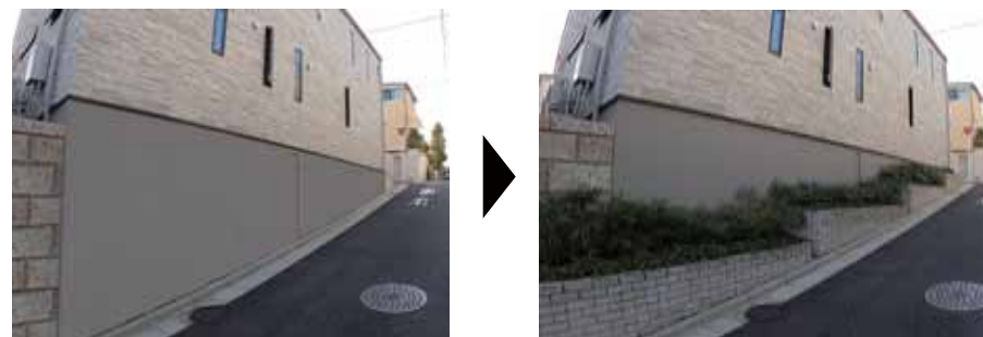
坂道に面する擁壁に段差をつけて植栽し、地形の変化を感じられるデザインとした例。
