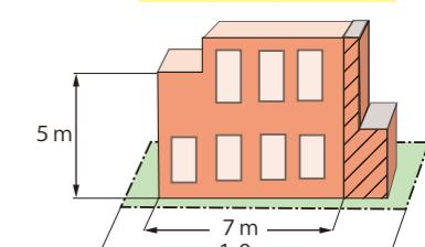
例えば、図のように環七に接する敷地の長さが10mの場合、長さ7mまでの建物部分は高さ5m以上としなければなりませんが、長さ7mを超える部分(図の斜線部分)についてはこの制限は適用されません。
