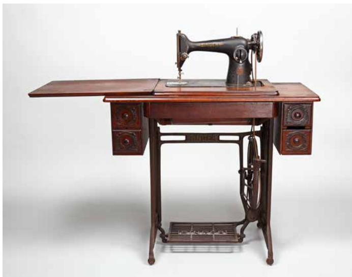
写真1 足踏みミシン (シンガー社) ミシン：新型式 201K 型 台：普及型 404 番型
