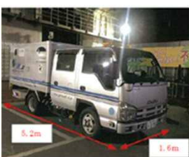
路面下空洞探査車
