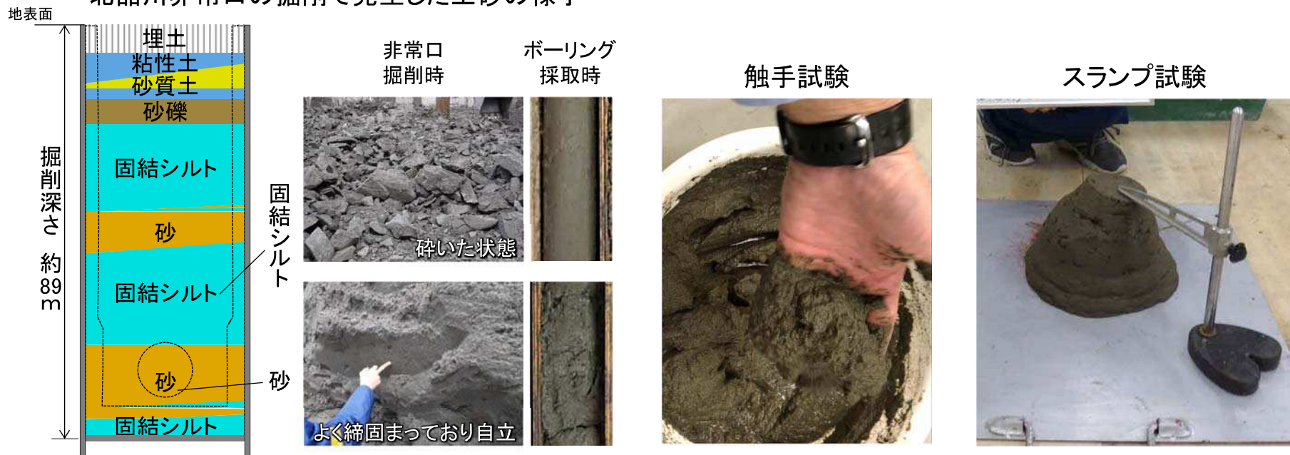
北品川非常口の掘削で発生した土砂の様子
