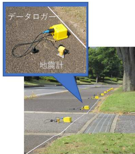
微動アレイ探査の概念(イメージ)
