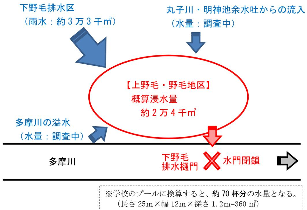
図-24 上野毛・野毛地区の浸水イメージ
