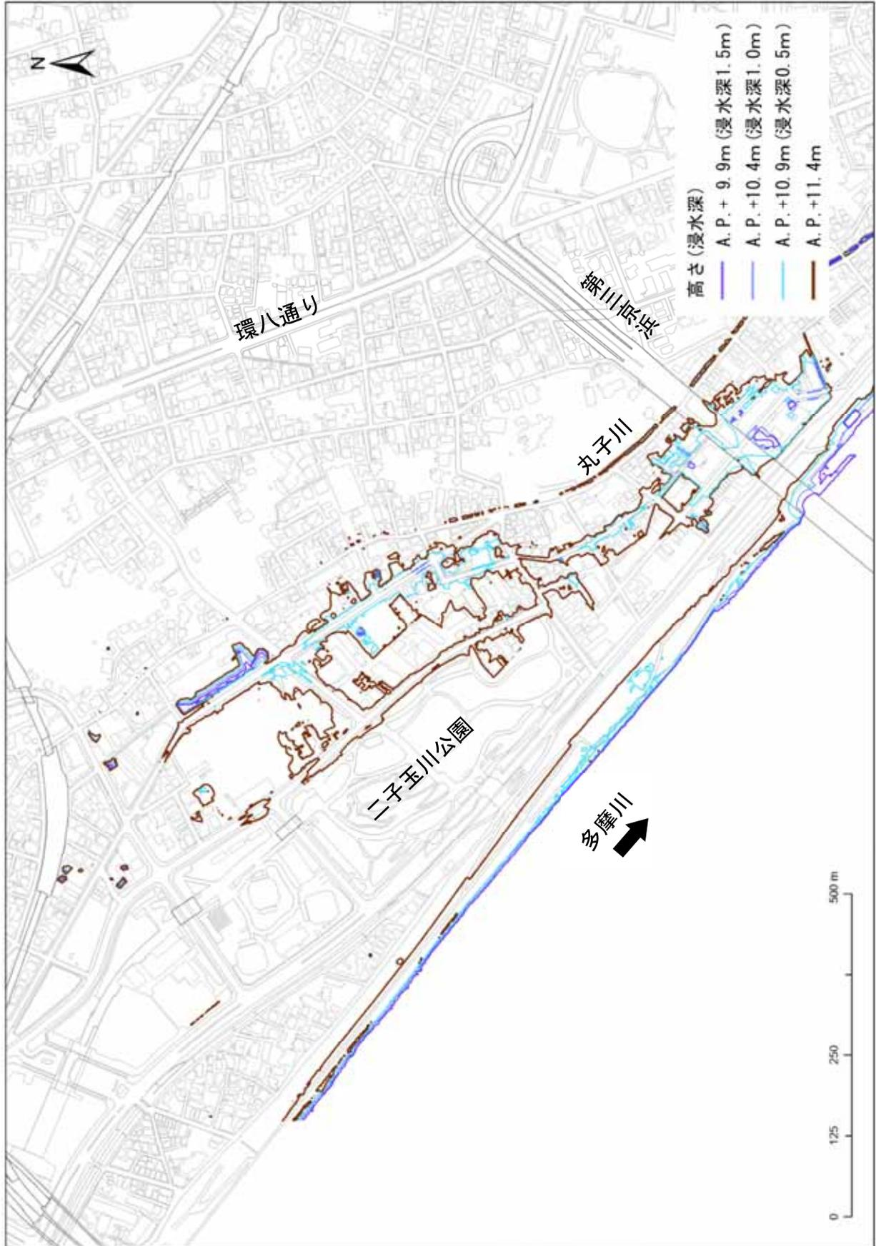
図-22 上野毛・野毛地区の浸水範囲・浸水深さ
