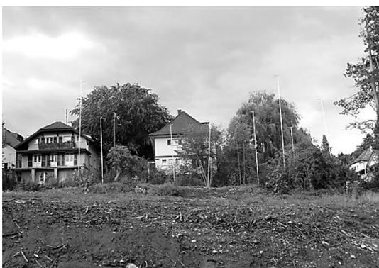
写真 18 計画中の住宅の大きさや高さを確認できるパイプフレーム (スイス)
