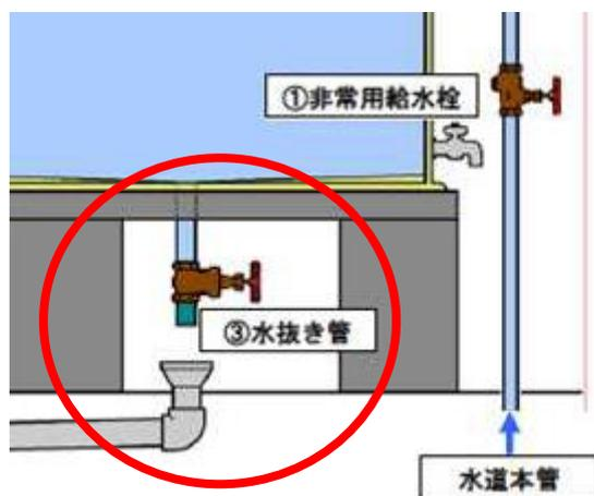
水抜き管は、ほとんどの場合、受水槽内の清掃時等にしか使用しないため以下の3点に十分注意するようにしてください（以下のような様子が見受けられた場合、使用を中止してください）。
