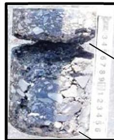
アスファルト混合物が層間剥離し、表層・基層が分離
