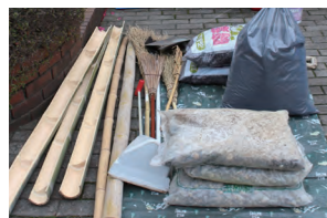
左 半割竹材、右手前 仕上げ用玉砂利、奥 竹炭、腐葉土など
