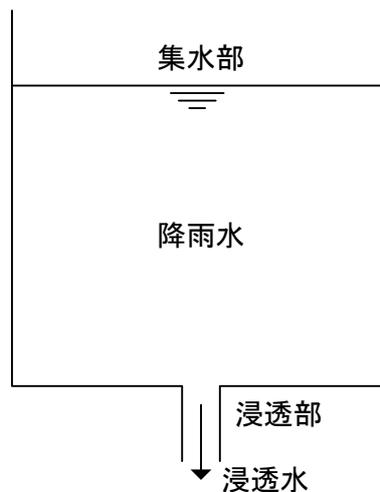
図 4.4 浸透施設のモデル
