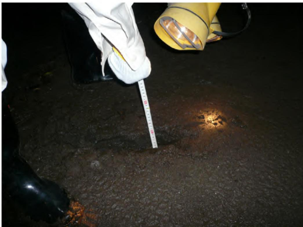
図 7.1 地下貯留槽に貯まった土砂
