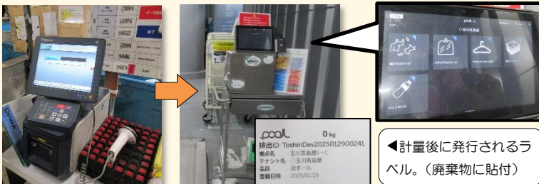
▲以前の計量システム（左）とリニューアル後の計量システム（右）。直感的に操作でき、ラベルを廃棄物に貼付することで適正管理ができる。
