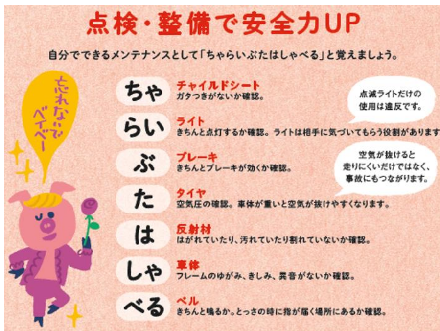
図 4-5 自転車の点検整備方法（『子育て自転車の選び方&乗り方』より抜粋）
