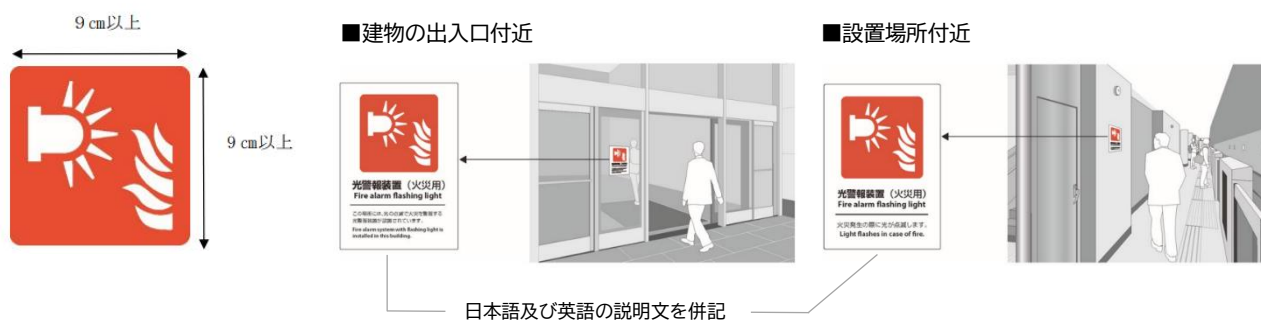
【図 20-11】 光警報装置の案内図記号（光警報装置ピクトグラム）と設置例
