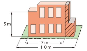
例えば、図のように環七に接する敷地の長さが10mの場合、長さ7mまでの建物部分は高さ5m以上としなければなりません。ただし、長さ7mを超える部分(図の斜線部分)についてはこの制限は適用されません。
