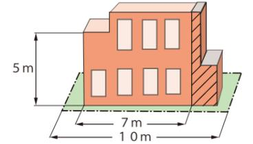
例えば、図のように環七に接する敷地の長さが10mの場合、長さ7mまでの建物部分は高さ5m以上としなければなりません。長さ7mを超える部分(図の斜線部分)についてはこの制限は適用されません。
