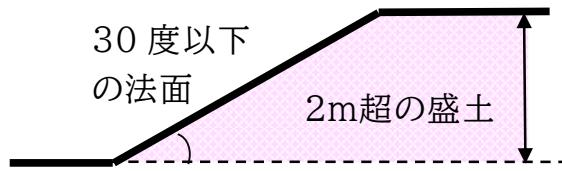
③高さが30cmを超える盛土又は切土をする部分の面積の合計が500m<sup>2</sup>を超える場合
