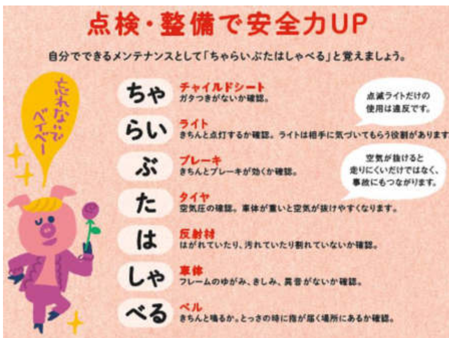
図 38 自転車の点検整備方法（『子育て自転車の選び方&乗り方』より抜粋）
