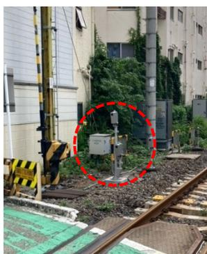
図 89 従来のレーザー式障害物検知装置
