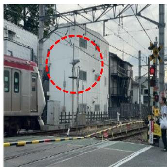
図 90 3D障害物検知装置
