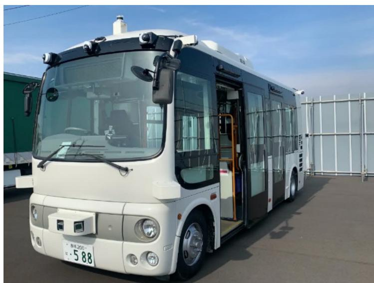
図 41 LiDAR を搭載した小型バスの例
