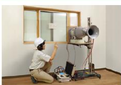
断熱改修後に気密測定も実施し、気密性能(C値)を確認しました
