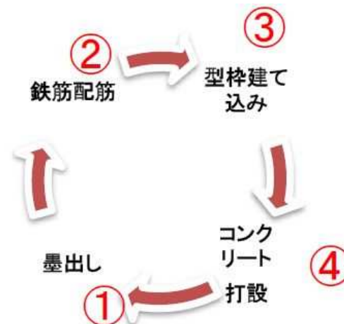
コンクリート打設サイクル
