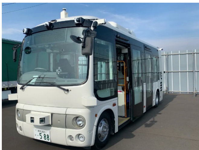
図 39 LiDAR を搭載した小型バスの例
