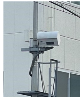
図 89 3D障害物検知装置
