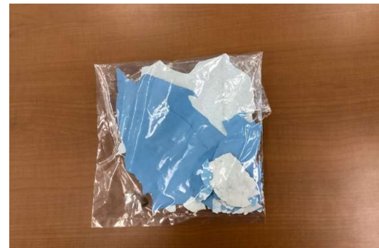
入水前のプール清掃で回収した塗装片
