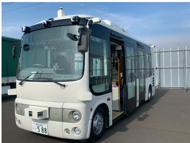
図 39 LiDAR を搭載した小型バスの例
