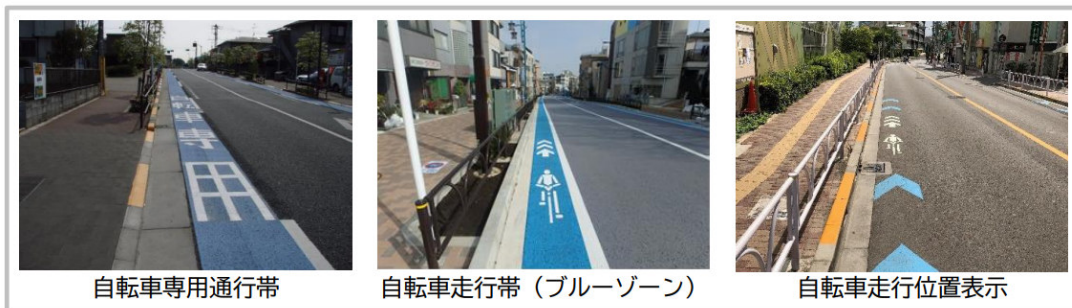
図 120 自転車走行環境整備（自転車通行空間の整備形態） 出典）世田谷区自転車活用推進計画及び自転車等の利用に関する総合計画（世田谷区、令和３年（2021年）７月）
