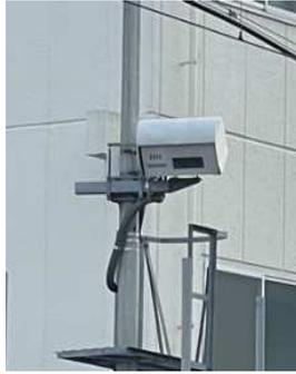
図 8 8 従来のレーザー式検知装置
