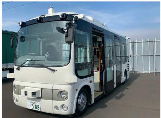
図 39 LiDARを搭載した小型バスの例
