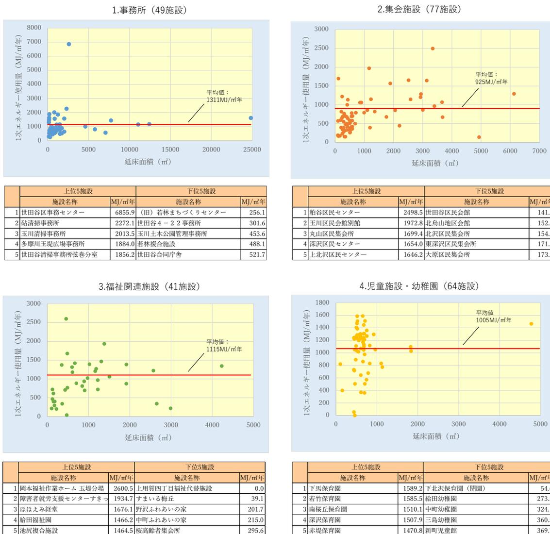
図 2-5 施設用途別の延床面積と一次エネルギー消費量の関係
