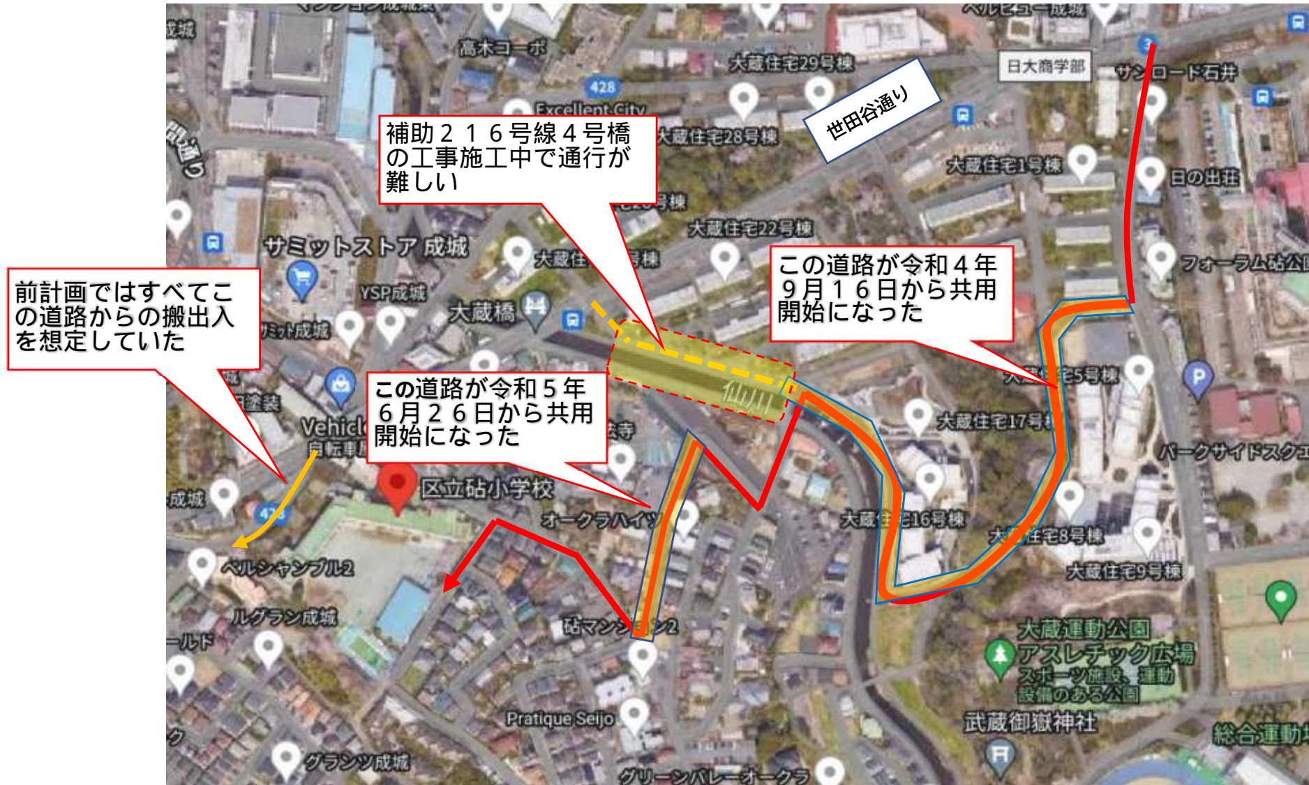
参考資料：砧小工事搬入経路の見直し図（プール解体、仮設校舎建設時）
